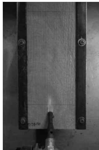
Fotografia 4 – Chama não atinge a marca de 150 mm.
